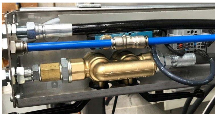
Installazione della valvola all'interno della macchina AUTOSWAB di Graphoidal
